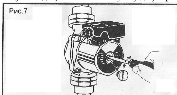
Если насос не запускается, устранить блокировку (рис.7). Блокировка может быть вызвана длительным простоем насоса либо попаданием примесей в воду.
